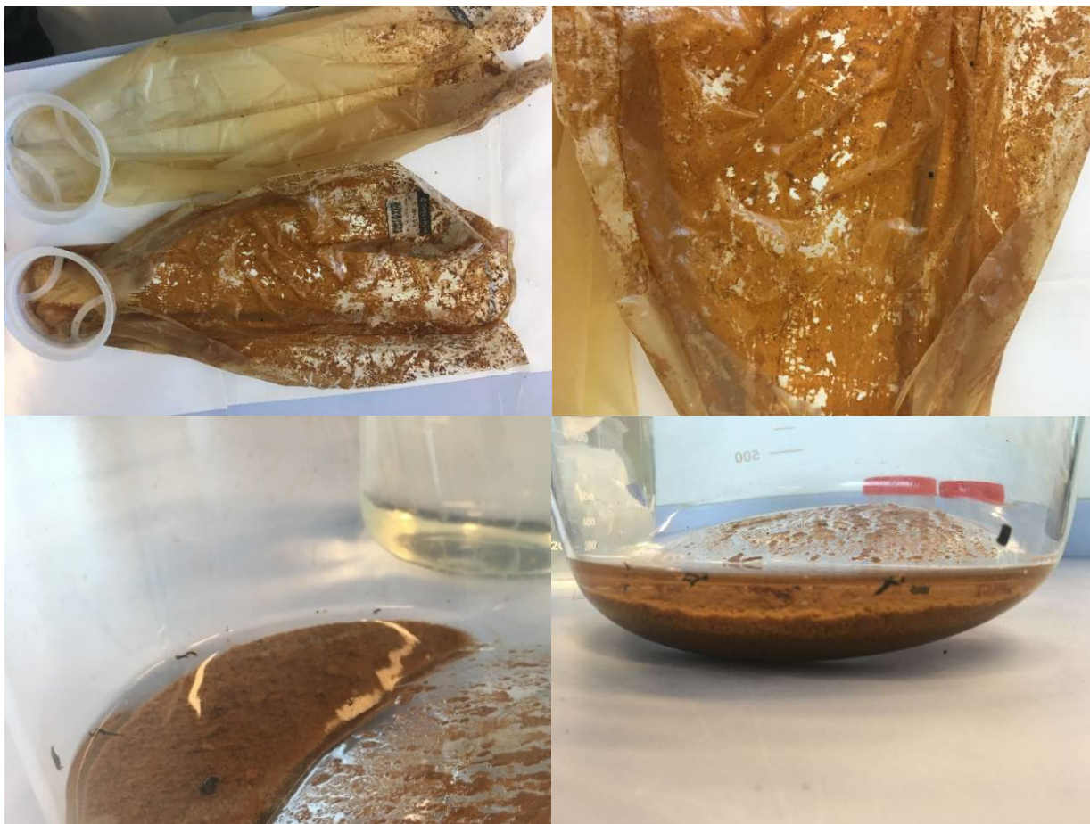
Figuur 2.4. Opegeknijpte filterzakken met roodbruine neerslagen
