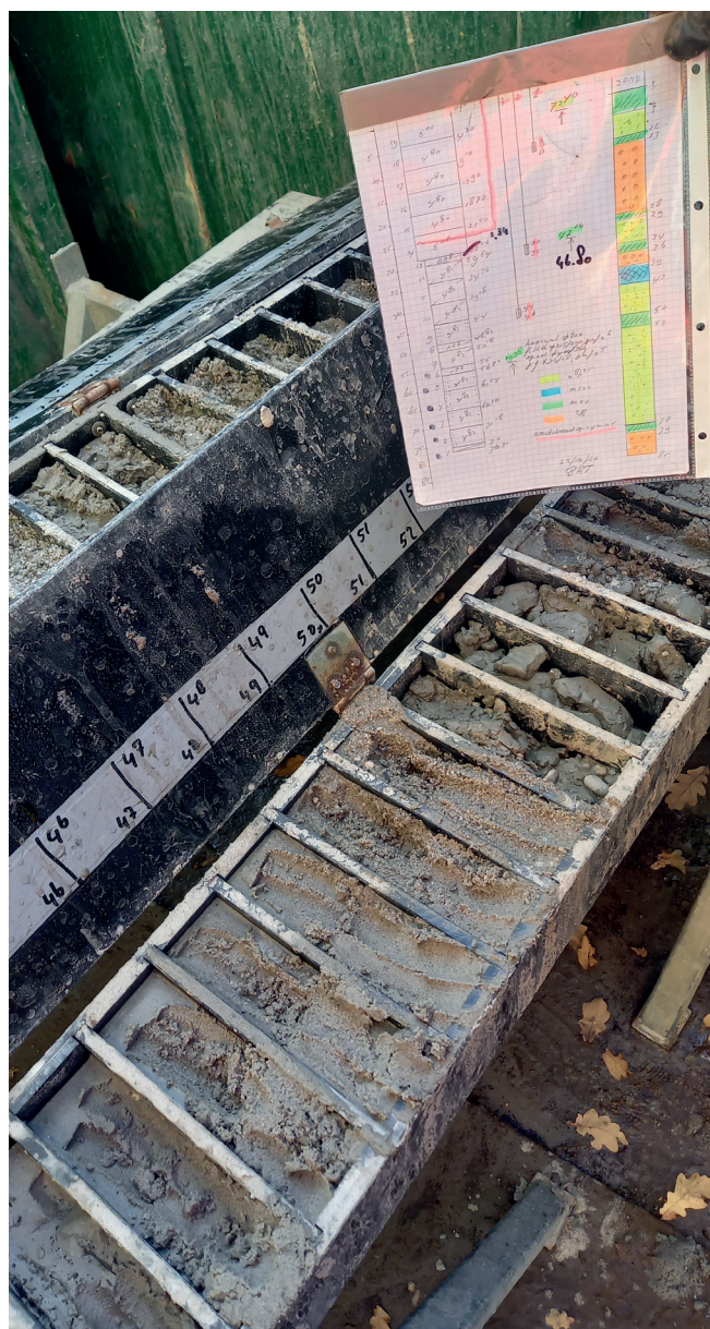
Afb. 4: Elke meter wordt er een grondmonster genomen, op basis hiervan weet Jan hoe de grond is opgebouwd en hoe hij later de boorgang weer aan moet vullen.
