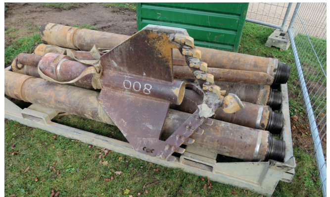
Afb. 2: Boorkop voor de bronboringen (ca. 80 cm diameter).
