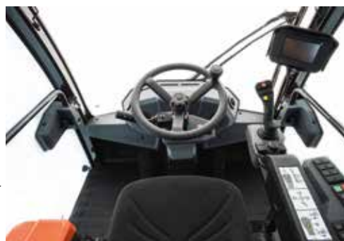
De machine heeft armluningbediening, een tweezijdig verstelbaar stuur, een moderne stoel en dito klimaatregeling.
