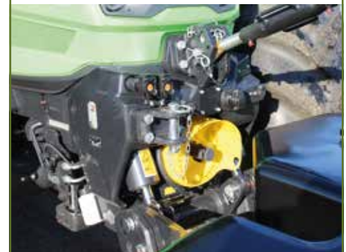
Net als op de 7-serie is de tweetoerige frontaftakas (1000 en 1000E) een optie. Hij is gesynchroniseerd met de aftakassnelheden achterop.
