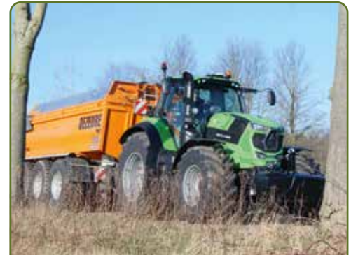
De nieuwe SDF-CVT heeft twee rijbereiken, waarbij er rond de 18 km/u en 1600 toeren onder last wordt geschakeld. Daar voel je niets van.
