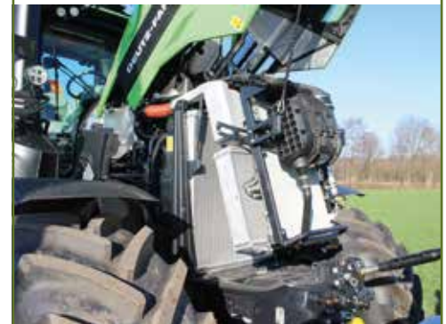
De 8280 TTV weegt tien ton en de 6,1-liter-Deutz-motor in het vooronder levert 211 kW (287 pk). Dezelfde motor zit ook in de 7-serie, maar kreeg in de 8280 TTV een tweede turbo.
