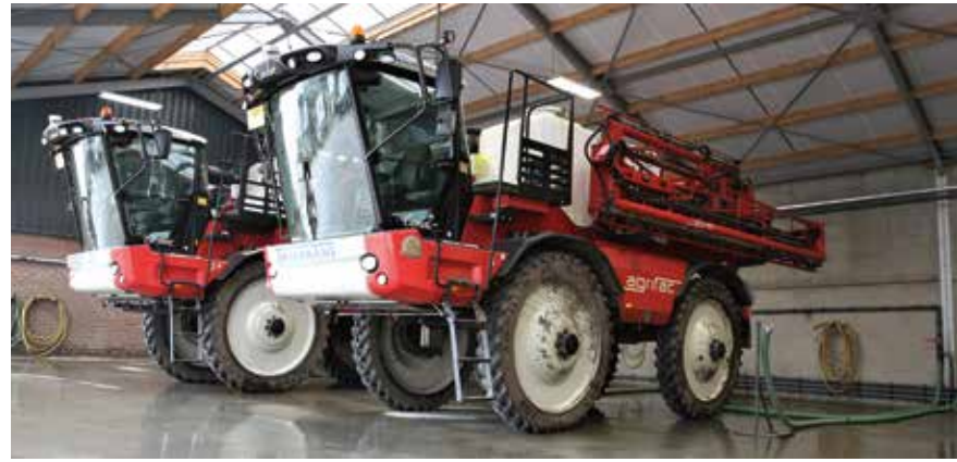
De spoelplaats met vloeistofdichte vloer is ruim bemeten. Er zijn per machine twee slangen, één voor het vullen en één voor het aftappen.
