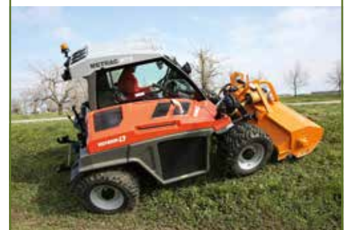
Een laag zwaartepunt en de wielen op de hoeken. De Metrac is heel stabiel, ook door de grote pendelweg van de vooras. Dankzij liefst vijf stuurstrategieën kun je voorkomen dat je afglijdt.
