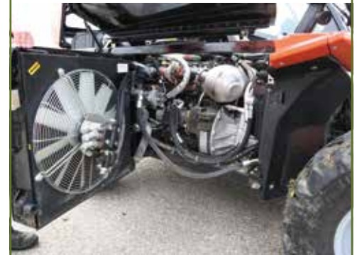
Reform wisselde van motorleverancier VM naar Perkins. De koelervin is hydraulisch aangedreven en de draairichting verandert regelmatig.
