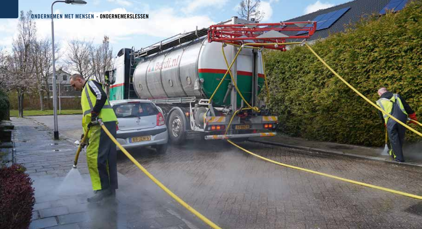
Berdi heeft een vrachtwagen omgebouwd voor het onkruid bestrijden met heet water. Daarmee is een grote dagcapaciteit mogelijk.
