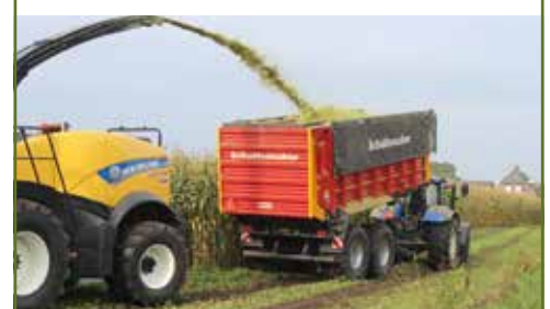
Door te kippen wordt het oppervlak vergroot waarop de hakselaar kan mikken en is de kans dat er maïs naast de bak valt kleiner.
