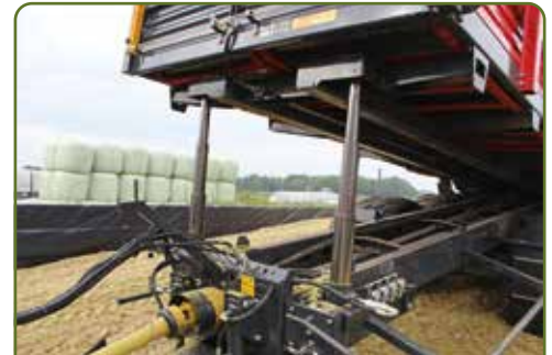
Beide cilinders tillen de bak aan de voorzijde slechts 1,10 meter omhoog tot de bak in een hoek van ongeveer twintig graden staat.
