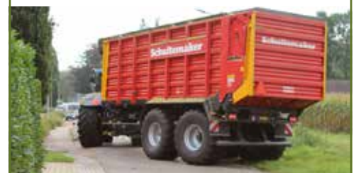
De wagen is volledig aan te kleden met opties als hydraulische sturing en vering van de tandem. Ook mechanische aandrijving is een optie.
