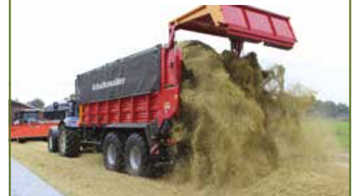
Kippen om sneller te lossen, is niet nodig. De bodemketting en verdeelwalsen lossen snel genoeg en verdelen laagsgewijs.
