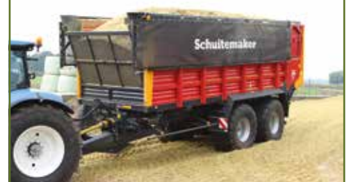
Op de kuil gebruikt Bouwhuis de kipcilinders niet vanwege de stabiliteit en om druk op de achteras van de trekker te houden. Op de spiegels is op deze locatie prima de sleufsilos in te rijden.
