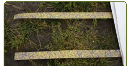
Er zit nauwelijks verschil tussen het vloeistofgevoelige papier dat we in de buitenbocht hebben neergelegd en dat wat in de binnenbocht lag.
