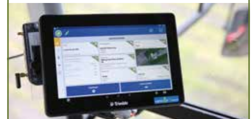
BBLeap heeft geen eigen bedieningsscherm. De LeapBox wordt bediend via een virtual terminal. Hier is dat via de terminal van het GPS-systeem.
