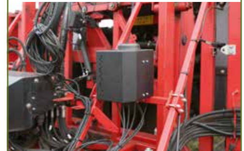
De LeapBox is een black box die achterop de machine wordt gebouwd. Hij bevat onder meer een krachtige controller en een modem.
