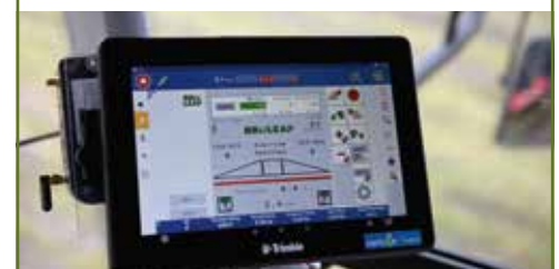
Het systeem werkt heel gebruiksvriendelijk. Het enige wat de chauffeur moet ingeven, is de gewenste hoeveelheid en de druppelgrootte.
