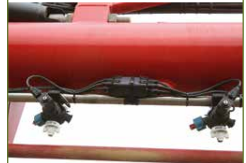
Op de sproeiboom wordt per vier doppen een module bevestigd, van waaruit een kabel naar de bedieningsklep gaat. De RS110-08-dop is een dop met voldoende capaciteit.
