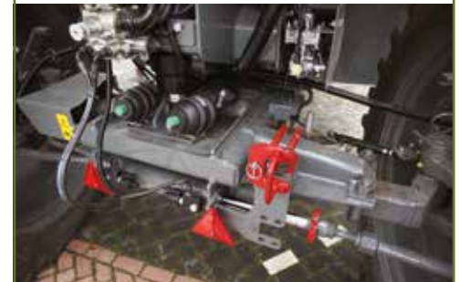
Tussen de twee stikstofballen zit de centrale cilinder van de hydraulische asvering. Verder de stuurstangen met sensoren voor de middenpositie.
