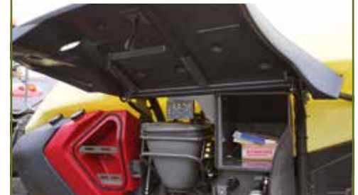
De opgeklapte TurboFiller-vultrechter. Daarboven nog het oude bedieningspaneel. In het rood de schoonwatertank, met geïntegreerd opbergvak.
