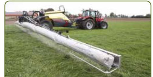
Het wachten was in Nederland op de Twin Force-luchtondersteuning. Daarmee is een driftreductie van 99 procent te realiseren.
