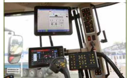
De HC 9600-bedieningsterminal wordt bij uitlevering van de machines vervangen door een HC 9700. Op de joystick de handmatige bediening van dertien secties.
