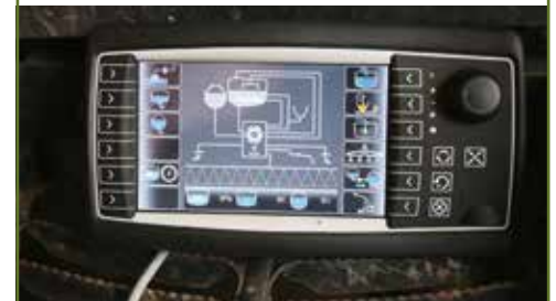
Het nieuwe bedieningspaneel, dat boven de vultrechter komt. Hierop zijn ook waardes af te lezen en veel meer instellingen te doen.
