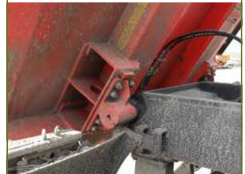
Het scharnierpunt van de bak draait op een doorlopende as van links naar rechts, wat moet zorgen voor meer stabiliteit.
