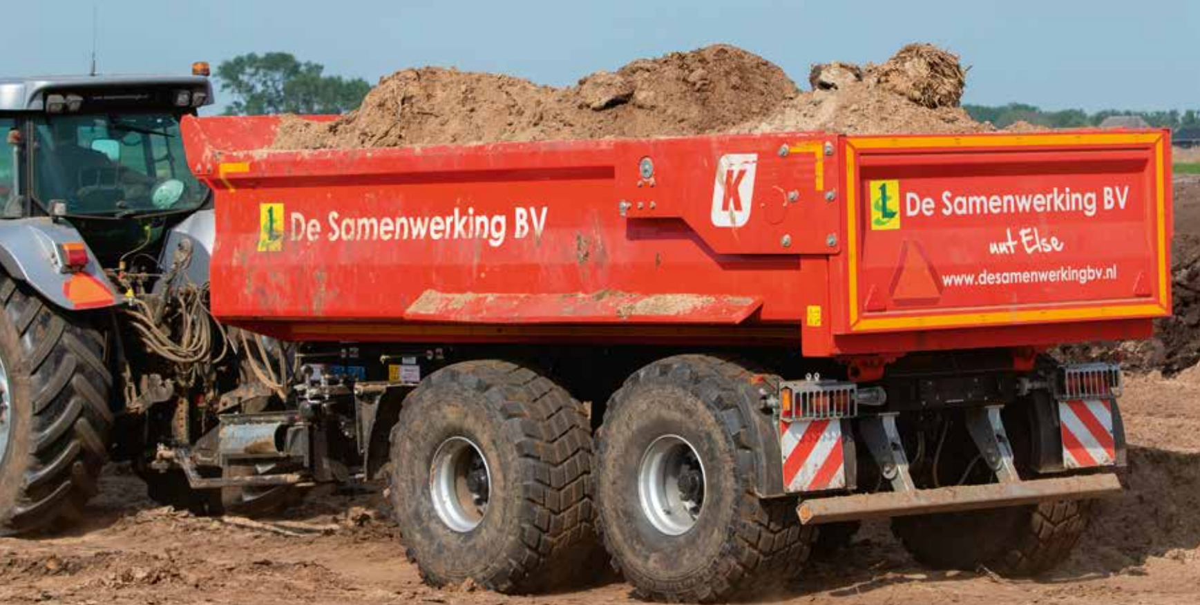
De eerste 24-tons gronddumpers van Kröger in Nederland hebben bij De Samenwerking al ongeveer 3500 uur gedraaid.
