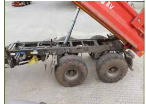
De wide-spread-tandemas staat op 1,81 meter voor meer comfort. Bij het kippen stempelt de achterste as af voor meer stabiliteit.
