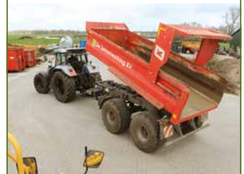
De cilinders van de achterklep zijn weggewerkt achter de kleparmen. Wanneer de klep omhoog staat, is er de meeste torsie en zijn de cilinders juist ingeschoven.
