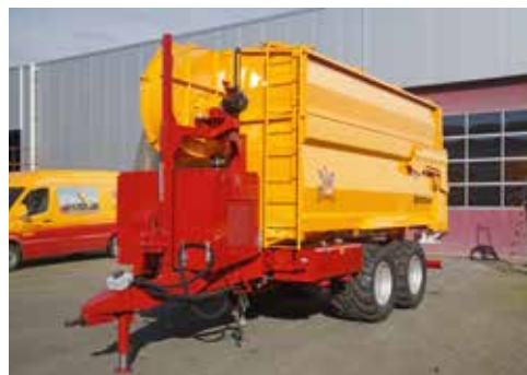
Deze 29-kuubs opvangwagen met eigen krachtbron heeft een hydraulisch aangedreven blower om het zo eenvoudig mogelijk te houden.
