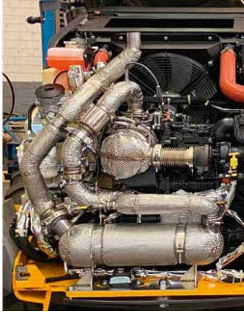
De NOx-killer, in feite een SCR-unit, is zo ingebouwd dat deze onder de bestaande motorkap past.
