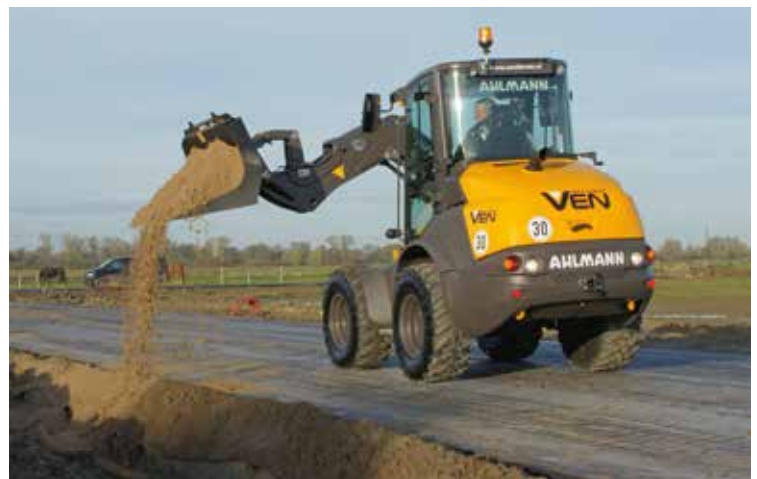
Van der Ven draait inmiddels volop met de AZ 95f met NOx-killer. Hij kan hierbij realtime de werkelijke NOx-uitstoot monitoren en desgewenst communiceren met opdrachtgevers.
