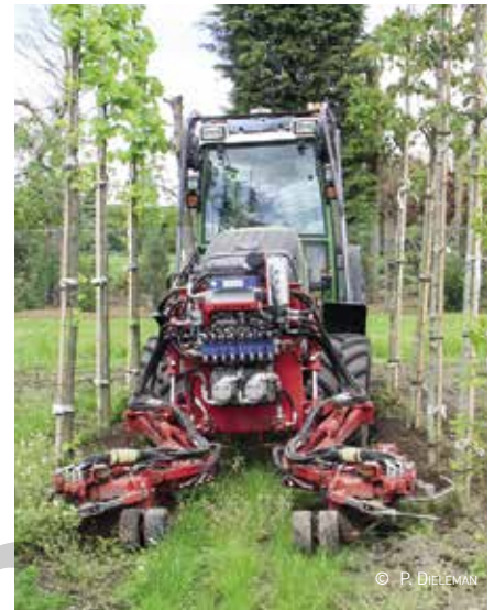
Een voeler duwt de maaiaarm weg, zodat die de stam niet kan raken.
