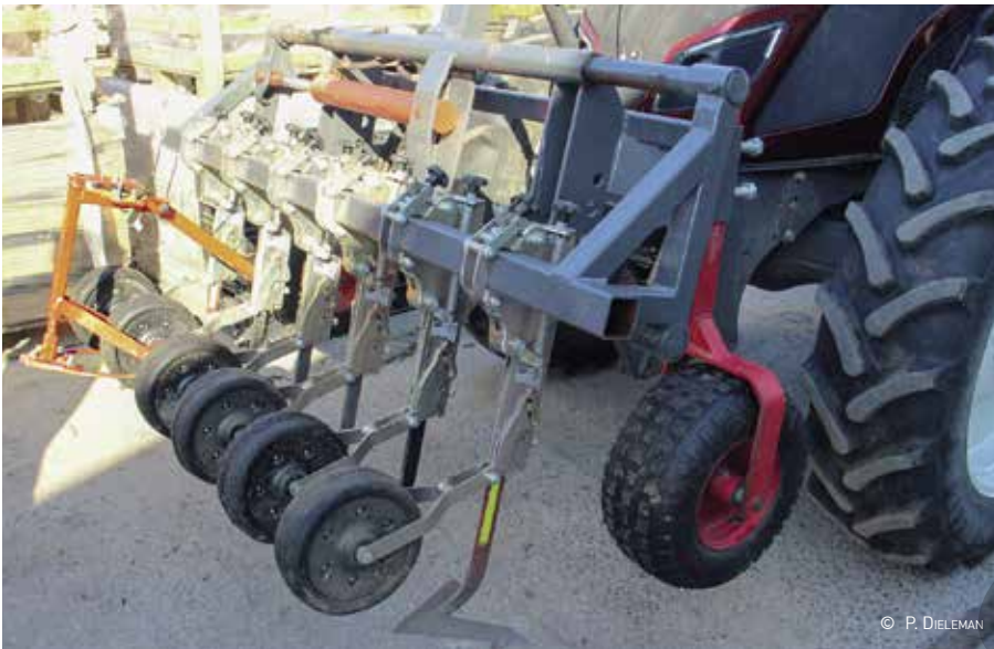
De schoffelmachine die Stijn zelf construeerde. Bemerkt de schoffelhouders met snelkoppeling, de bouten met handvat en de gele schaalverdeling, die wisselen en diepteregeling mogelijk maken zonder sleutelwerk. De arm links vooraan is de voeler die zorgt voor bijsturing.
