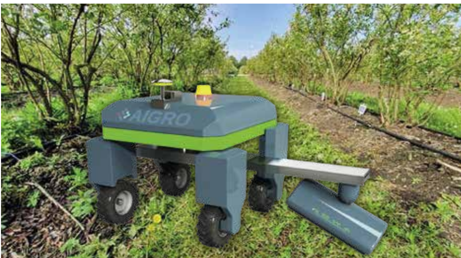
De Aigro brandt als het ware het onkruid weg door middel van een elektrische schok. De rechtse teeltstrook werd behandeld met de Aigro.
