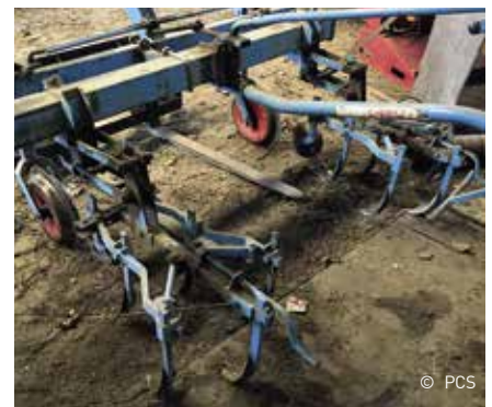
Schoffelmachine in de teelt van sierheesters
