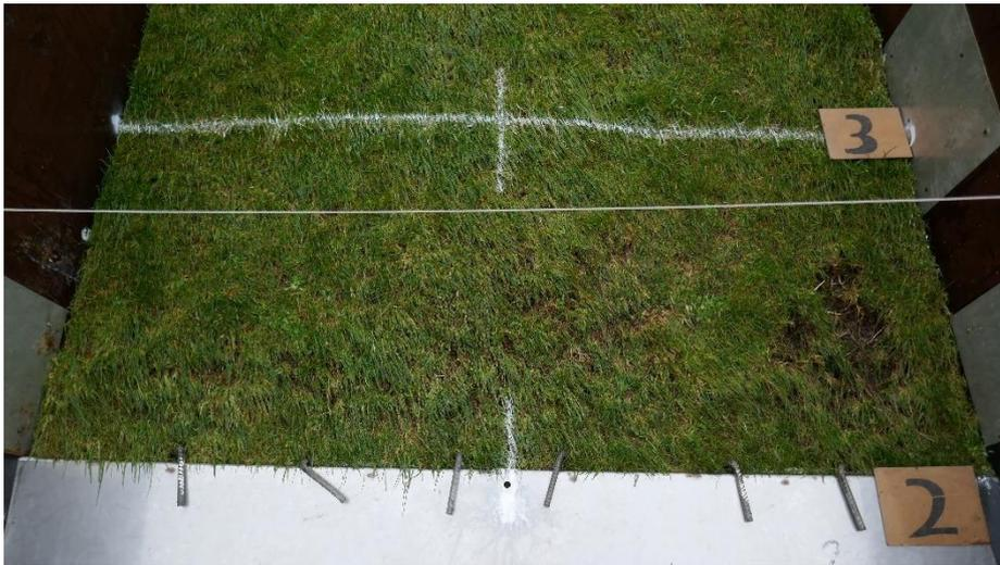
Figuur 5-19: Schade teststrook 3-1 na 16:18 uur (einde reguliere proef)
