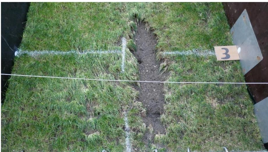
Figuur 5-13: Schade vak 3A teststrook 2-1 na 8:41 uur
