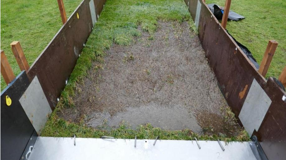
Figuur 5-21: Schade teststrook 3-1 na proef met maximale belasting
