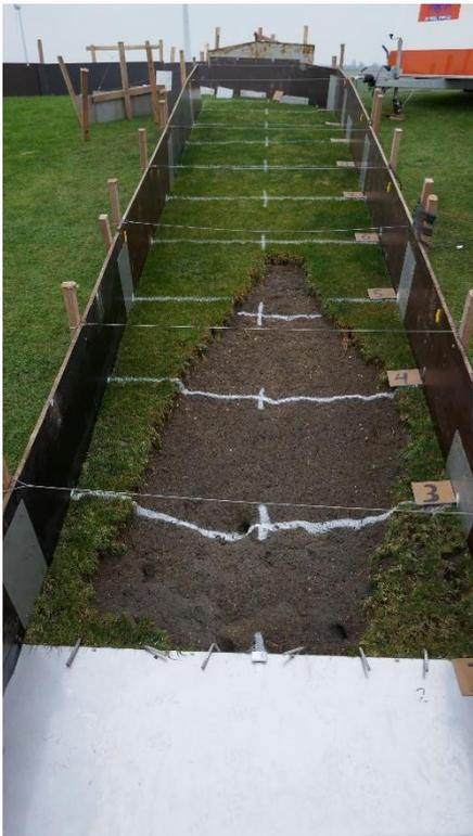
Figuur 5-16: Schade teststrook 2-1 na proef met maximale belasting
