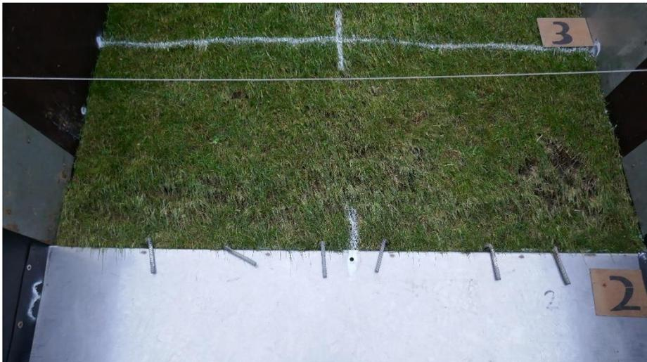
Figuur 5-18: Slijtage vak 3 teststrook 3-1 na 12:45 uur
