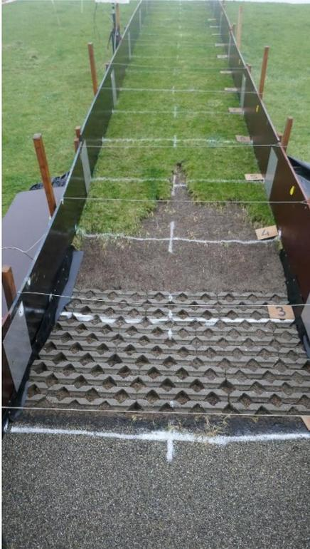
Figuur 5-27: Schade teststrook 3-2 na 17:17 uur (einde reguliere proef)
