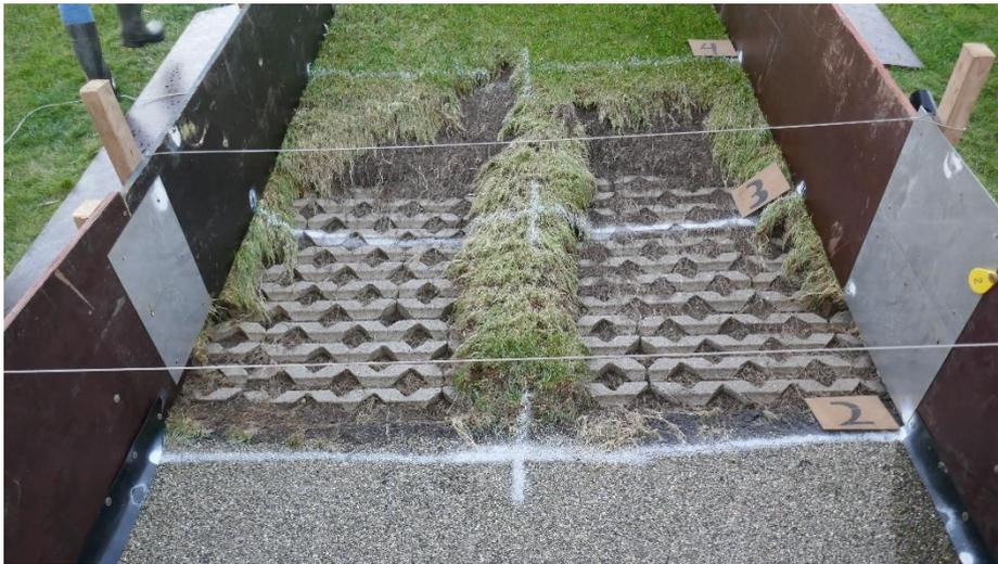
Figuur 5-24: Schade teststrook 3-2 na 4:47 uur
