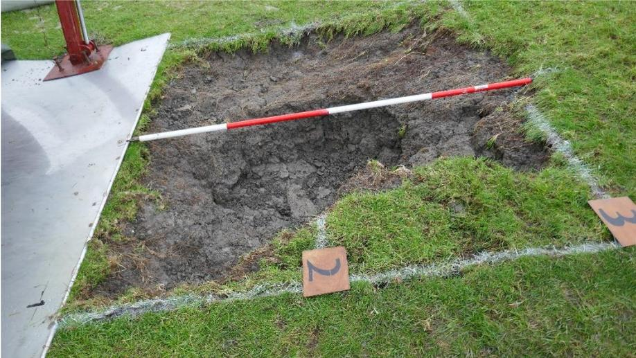
Figuur 5-8: Schade teststrook 1-1 na 6:45 uur
