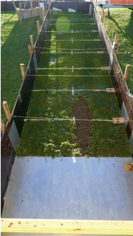
Figuur 5-14: Schade teststrook 2-1 na 13:22 uur
