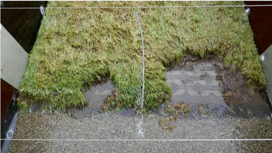
Figuur 5-23: Schade teststrook 3-2 na 1:19 uur
