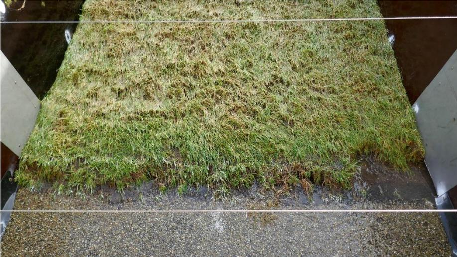
Ter plaatse van de doorgroeistenen was na 1 uur over een lengte en breedte van 20 cm de graszode weggeslagen, zodat de hieronder aanwezige doorgroeistenen zichtbaar werden (zie Figuur 5-23).
