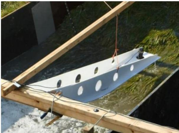
Figuur 4-2: De surfplank met paddle-wheel
