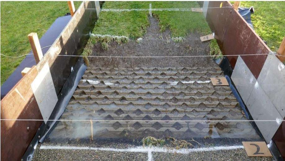
Figuur 5-26: Schade teststrook 3-2 na 8:38 uur (einde eerste sessie reguliere proef)
