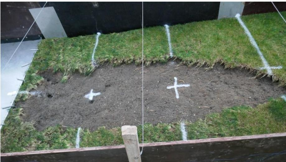
Figuur 5-15: Schade teststrook 2-1 na 2 uur proef met maximale belasting
