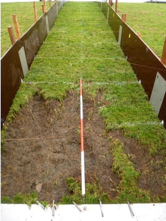
Figuur 5-7: Schade teststrook 1-1 na 6:30 uur
