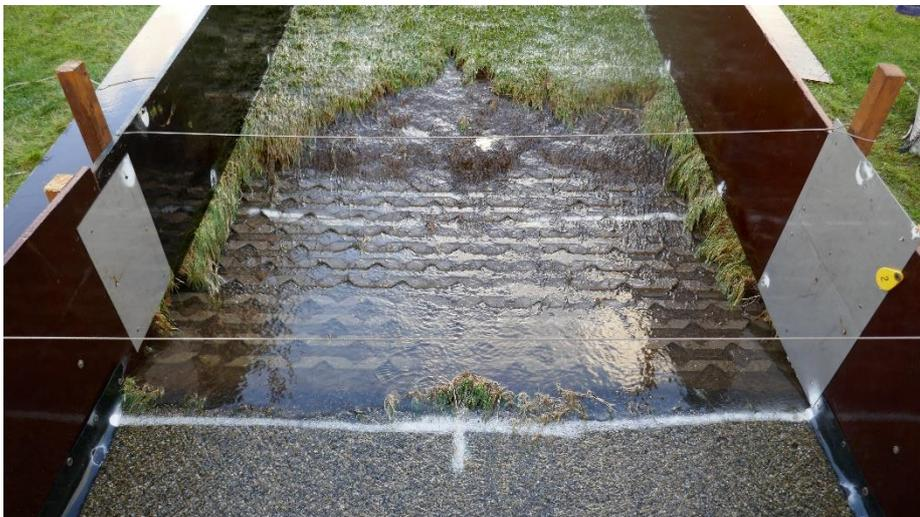
Figuur 5-25: Schade teststrook 3-2 na 5:06 uur
