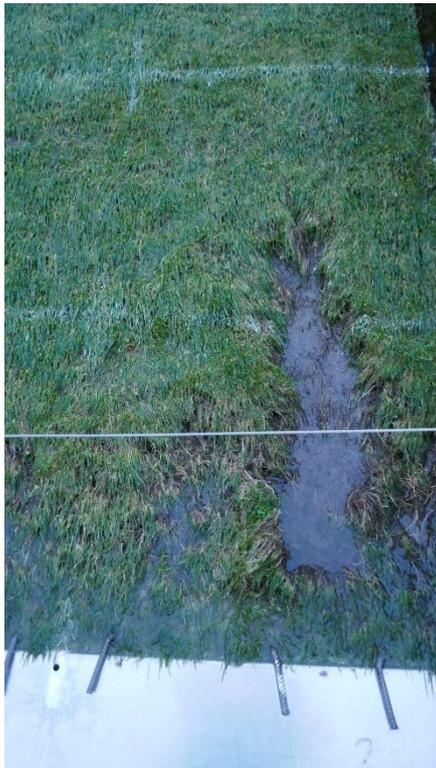
Figuur 5-20: Schade teststrook 3-1 na 1:30 uur maximale belasting
