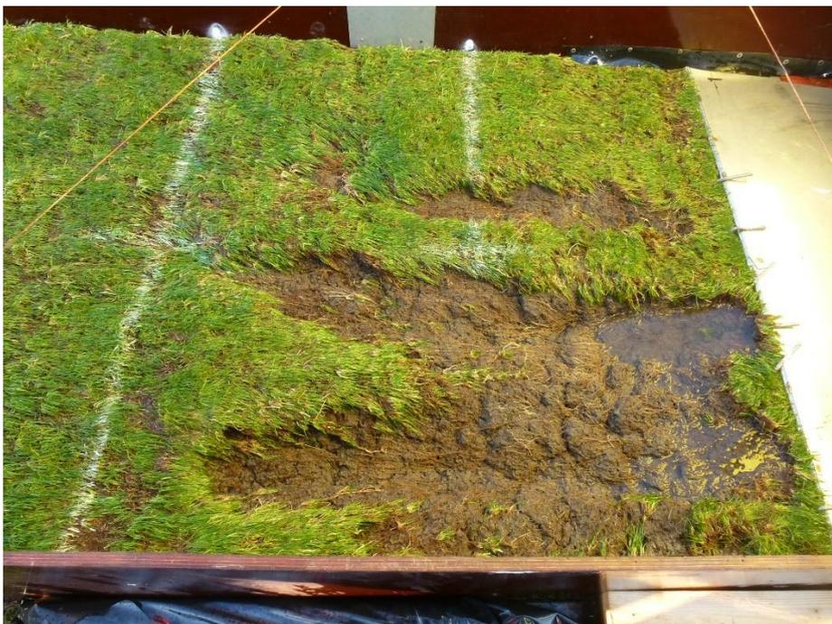
Figuur 5-6: Schade teststrook 1-1 na 6:00 uur
