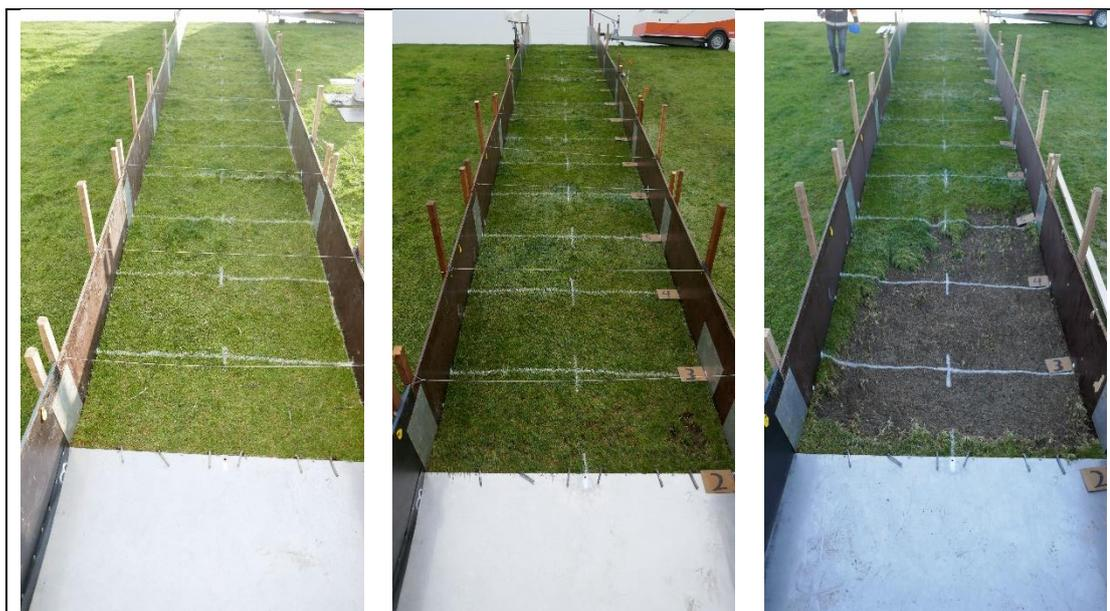
Figuur T3-1.27: Nulsituatie, einde reguliere proef (6 uur storm), einde proef maximale belasting
