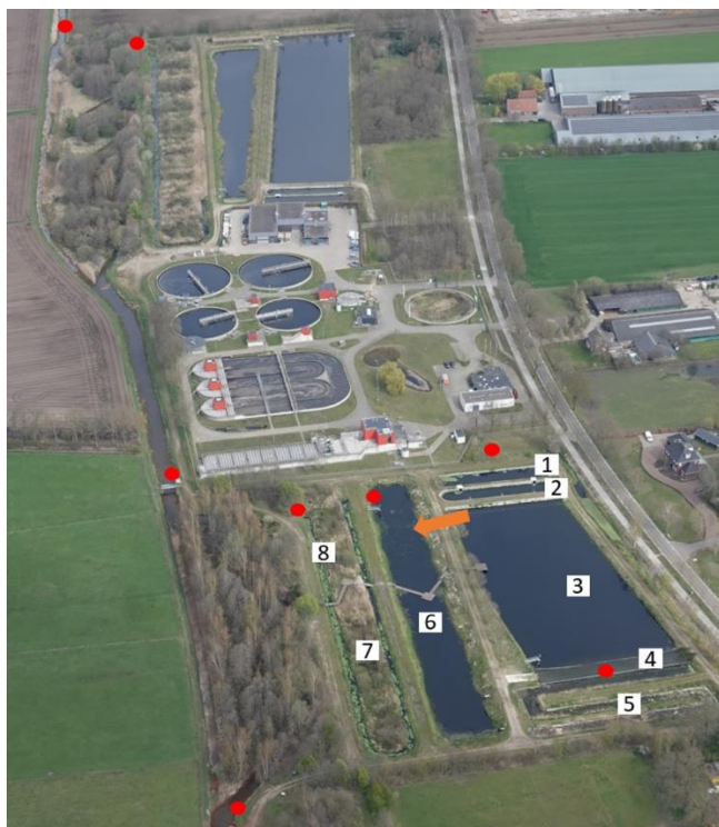
Afbeelding 1. Overzicht van het waterpark met de verschillende compartimenten (1-8). Bemonsteringsplekken zijn met rode stippen aangegeven
