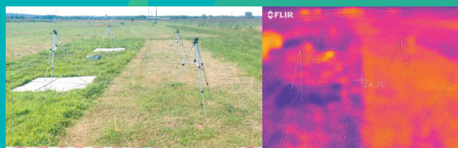
Foto 2 | Pilot veldmetingen bij weerstation de Veenkampen. Oppervlaktetemperatuur, bodemvocht en bodemtemperatuur metingen werden uitgevoerd op plots van 2x2 meter waarbij beheermaatregelen maaien en beregenen werd toegepast. Ook is een vergelijking gemaakt tussen gras en verhard oppervlak (beton)
