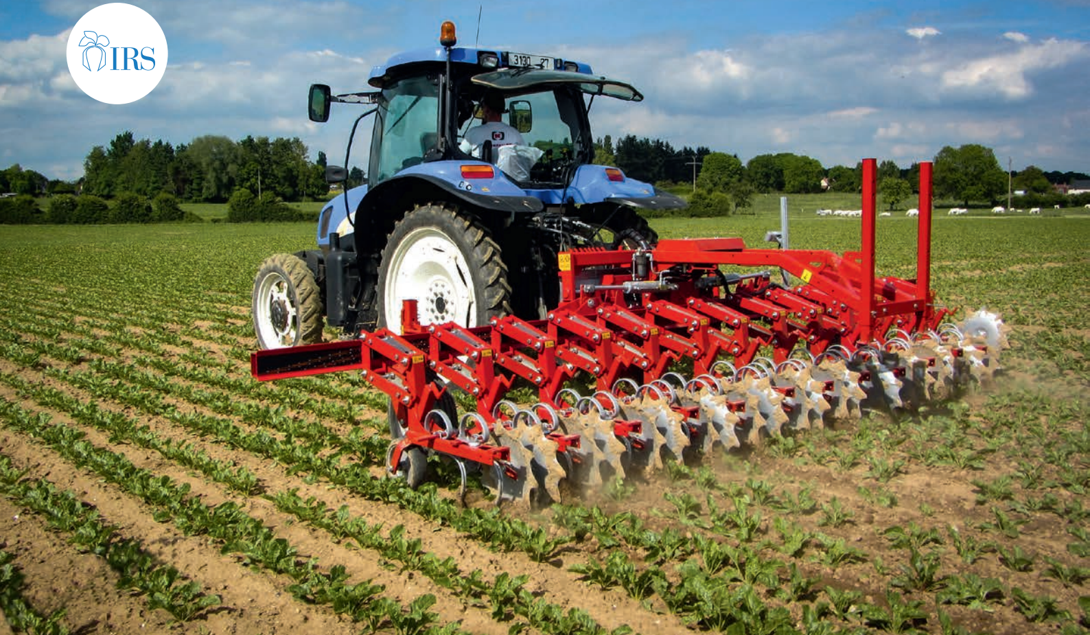
Cameragestuurde schoffelmachine, waardoor dichter langs de gewasrij geschoeffeld kan worden
