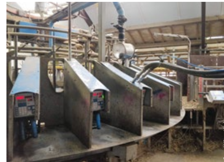
De 32-stands carousel met melkmeting functioneert prima, maar zou iets groter mogen zijn.
