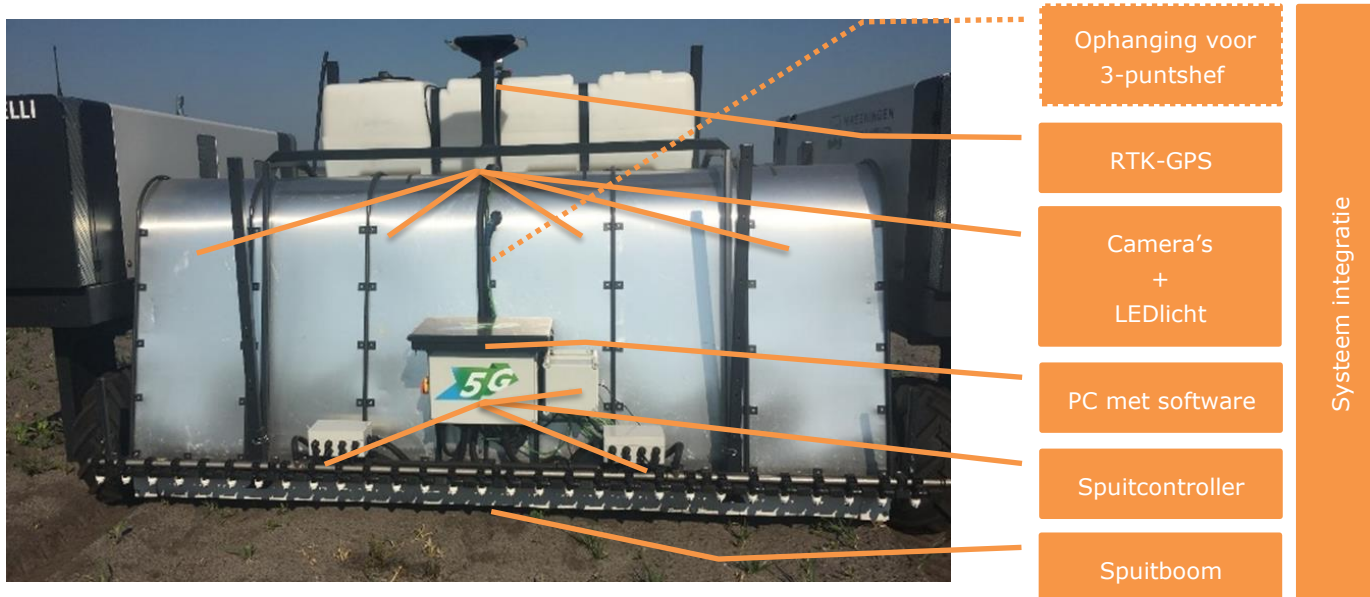
Figuur 1 Overzicht van hardware componenten Spot Sprayer
