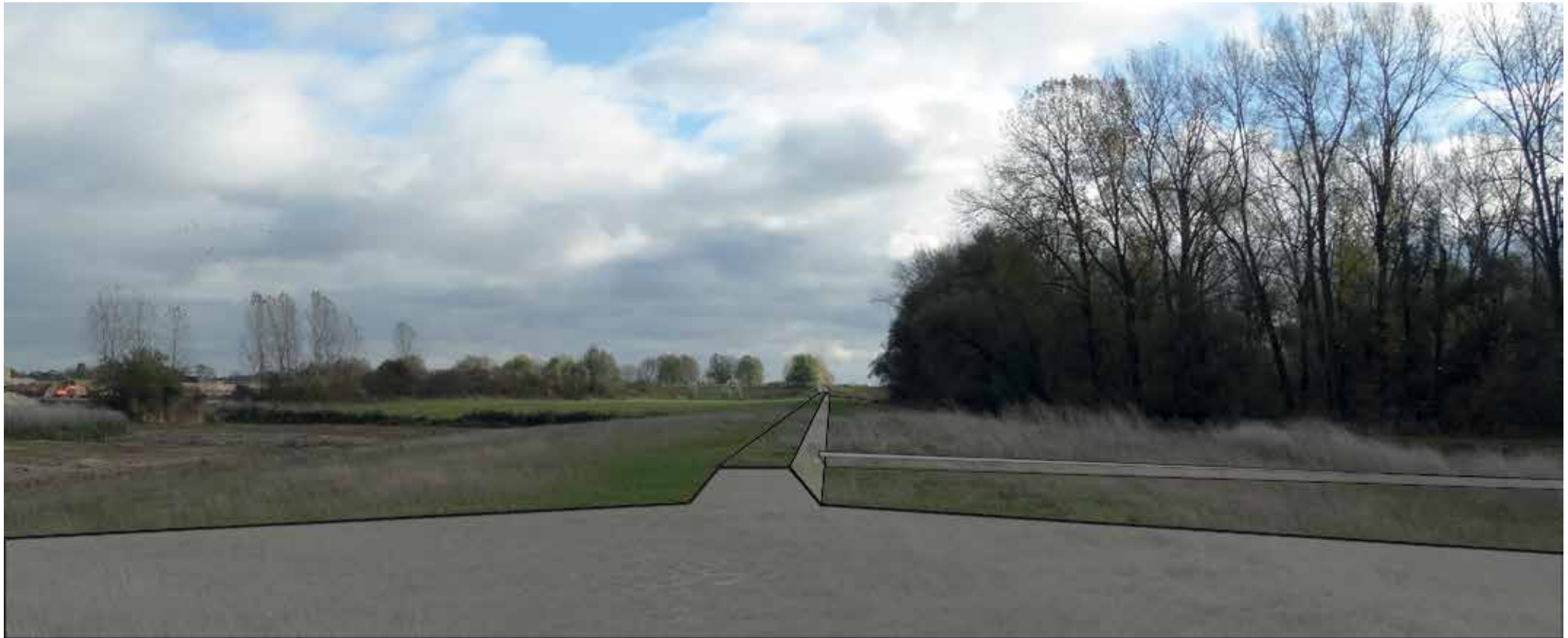
Figuur 11. Impressie van de voor de Schutdam voorgestelde her-profilering. Kruinbreedte 1.5 m; 'gekraagd' profiel van 1:2, resp. 1:7 en "haakse" afwerking aan het einde bij de Hoofdgeul. De nieuwe kade haakt niet aan op het einde van de Schutdam en is iets lager. (NB dimensies en hellingen niet op schaal.)
