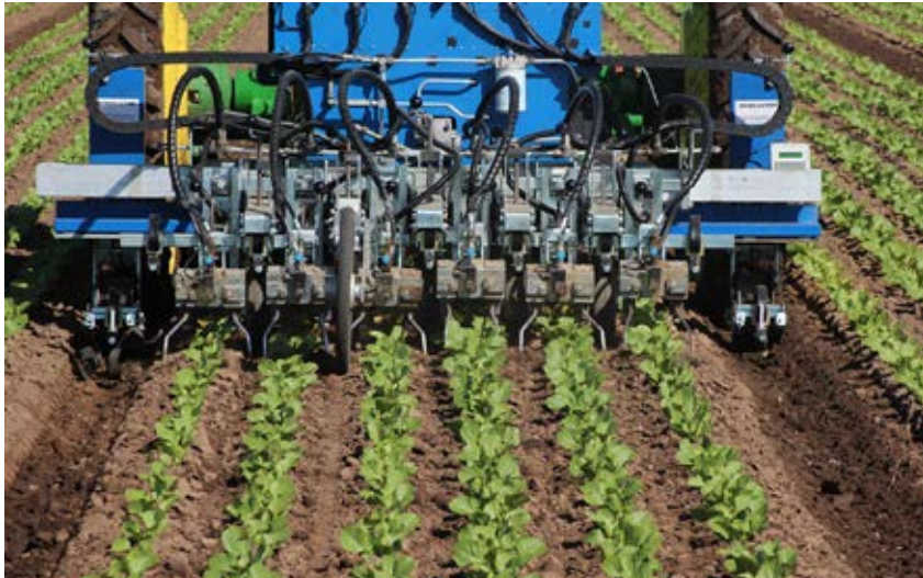
Op de Robovator wordt iedere rij apart gefilmd. Deze robot haalt een precisie van 95% in geplante en van 85% in gezaaide teelten.
