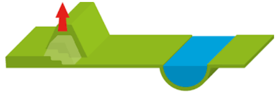
Figuur 10. Verhoging van een dijk. (Ruimte voor de Rivier, 2017)
