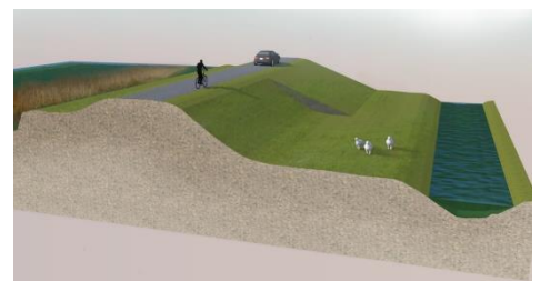
Figuur 15. Taludverflauwing van een dijk. (Adapt, 2019)
