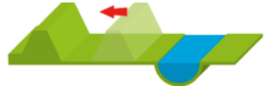
Figuur 11. Een dijkverlegging. (Rijkswaterstaat, 2017)
