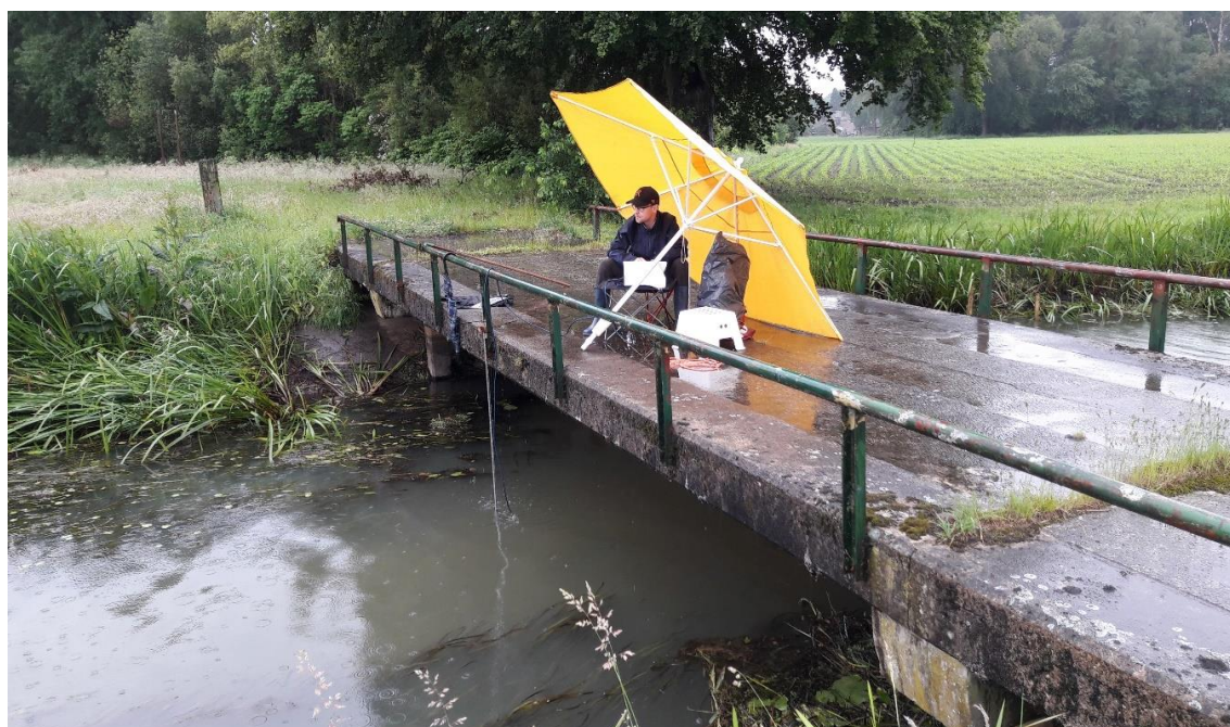
Figuur 4.3: Het verrichten van EMS stroomsnelheidsmetingen op de voetgangersbrug (12 juni 2019).
