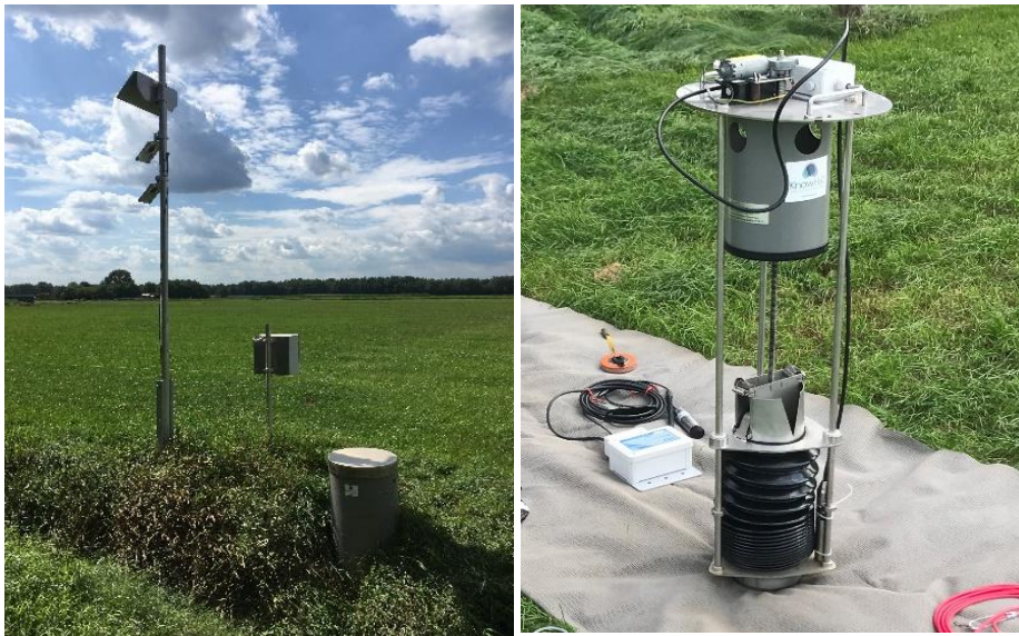
Figuur 4-2: KAD-opstelling bij dhr. Kremer. Op de linker foto staat links het zonnepaneel waarmee de balg wordt gevoed, in het midden het kastje voor de handmatige sturing van de balg, en rechts de regelput waar de balg in zit. Op de rechter foto is de balg weergegeven. Foto's: Gé van den Eertwegh.
