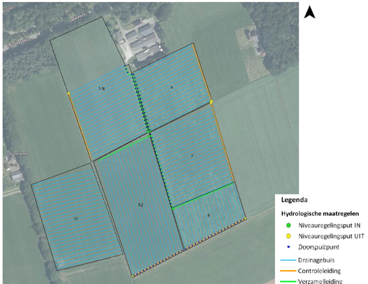
Figuur 3-7: Gedetailleerd geïnstalleerd drainagesysteem bij dhr. Hemstede (links, blok 11) en bij dhr. Spoelman (rechts, blokken 5N, 5Z, 6, 7 en 8). Kaart is aangeleverd door Ecogroen (d.d. 26-06-2018)
