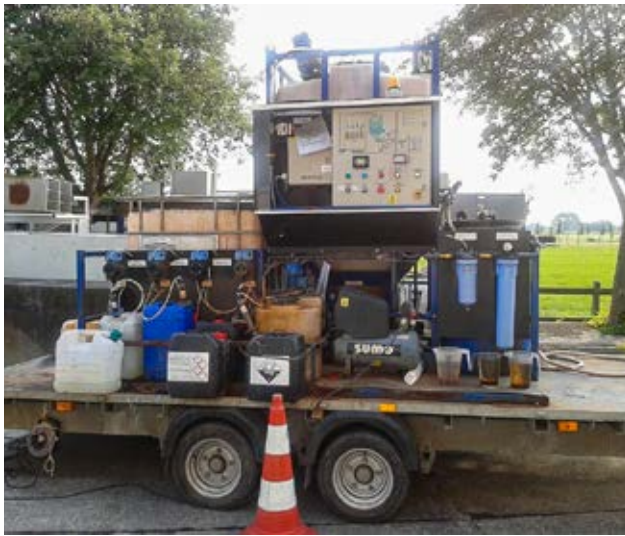
De Sentinel van Inagro kan op een aanhangwagen vervoerd worden om zo restwater op locatie te zuiveren.
