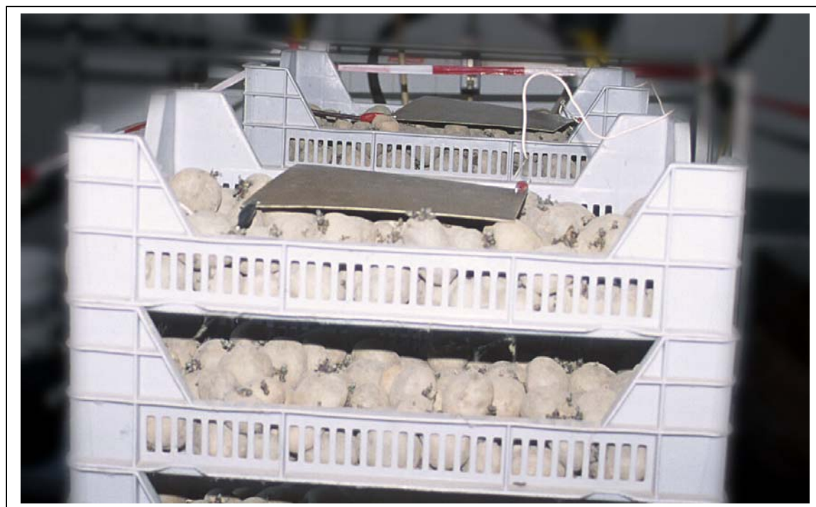
Figuur1. Op de aardappelen ligt een plaat waardoor een elektrisch veld geleid wordt door middel van een transformator.
