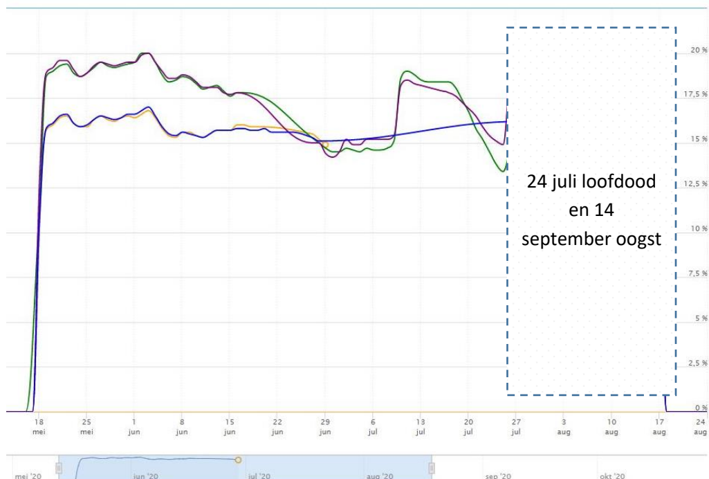
Figuur 16: Weergave resultaten sensoren breedspoor-proefveld, een uitdraai van het online Sensoterra-portal. Hier zijn de blauw en oranje lijnen de 3,2m. -objecten en de paarse en groene lijn de 1,5m. objecten. Belangrijk om te beseffen is dat de betrouwbaarheid van de verkregen figuur te wensen overlaat, zoals eerder besproken en tevens ook in de eindconclusie besproken wordt.
