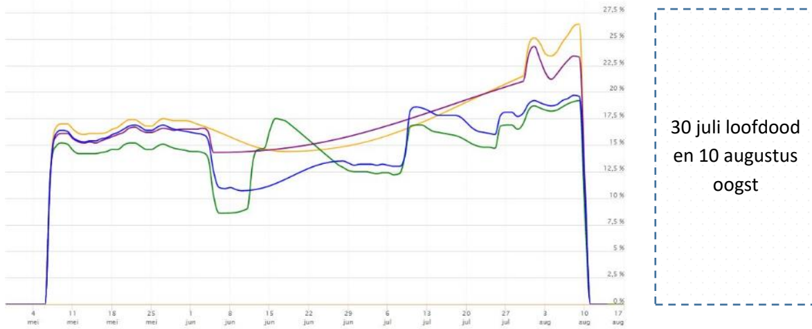
Figuur 20: Weergave resultaten sensoren Transformer1-proefveld, een uitdraai van het online Sensoterra-portal. Hier zijn de blauw en groene lijnen de WEL transformer velden en de paarse en gele lijn de ZONDER transformer velden. Belangrijk om te beseffen is dat de betrouwbaarheid van de verkregen figuur te wensen overlaat, zoals eerder besproken en tevens ook in de eindconclusie besproken wordt.
