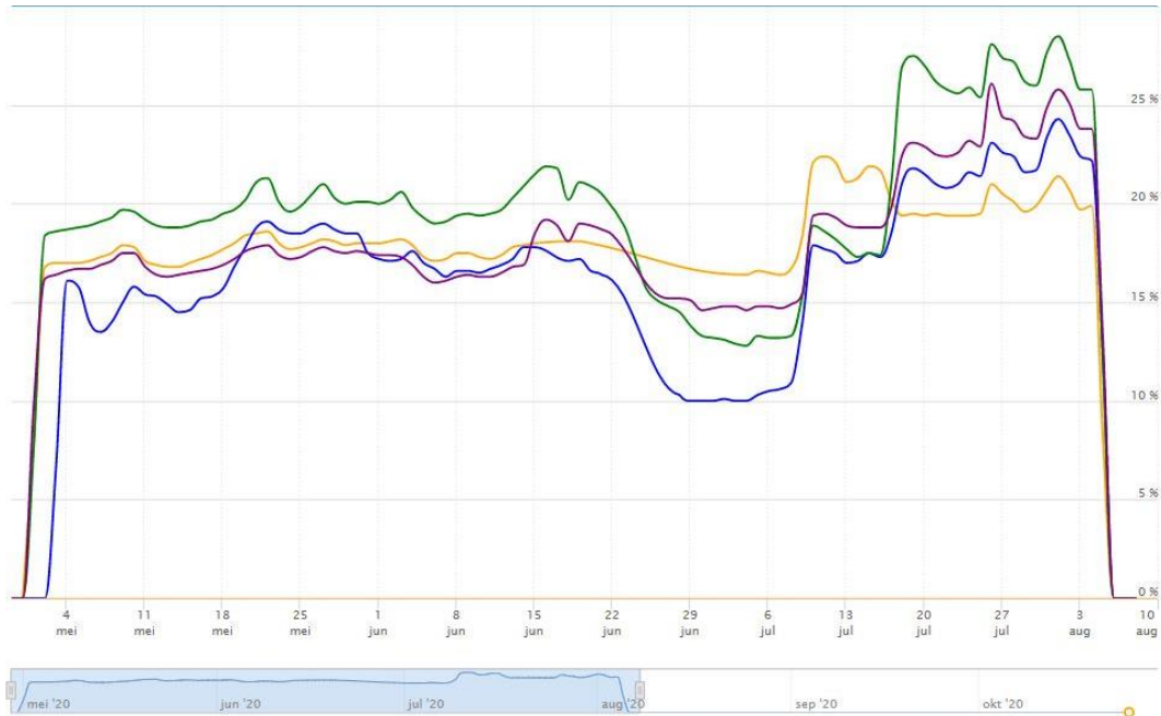
Figuur 24: Weergave resultaten sensoren Transformer2-proefveld, een uitdraai van het online Sensoterra-portal. Hier zijn de blauw en gele lijnen de WEL transformer velden en de paarse en groen lijn de ZONDER transformer velden. Belangrijk om te beseffen is dat de betrouwbaarheid van de verkregen figuur te wensen overlaat, zoals eerder besproken en tevens ook in de eindconclusie besproken wordt.
