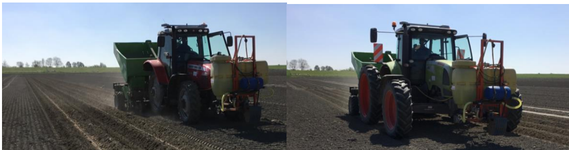
Figuur 12: Poten van de proef op 7 mei 2020, met links de 1.5m breedspoor trekker en rechts de 3,2m breedspoor trekker, rest van de poot-combinatie is identiek.
