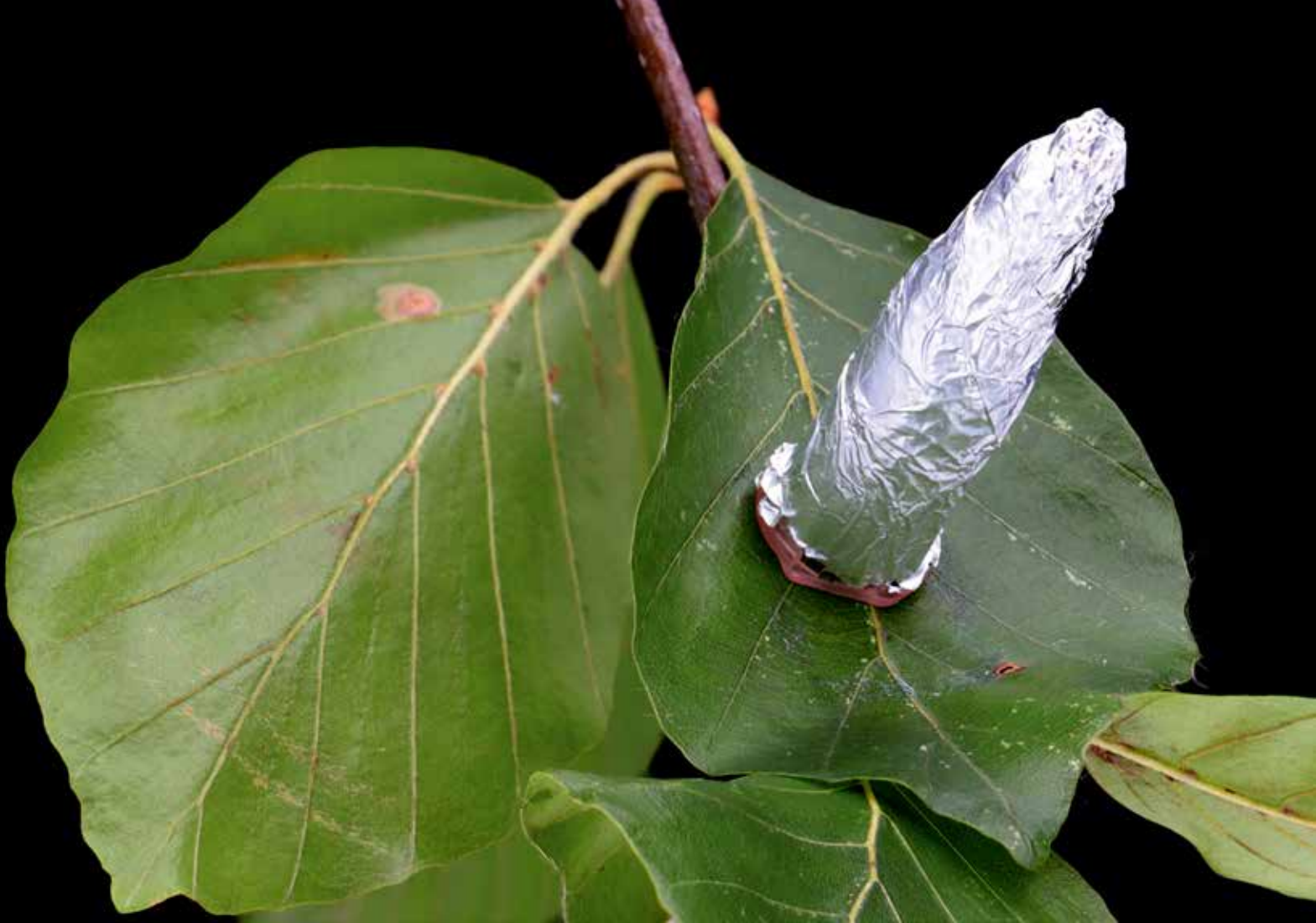
Figuur 1. Proefopstelling voor het zilvernitraatexperiment op een blad (bovenzijde) van een levende beuk. Het buisje werd in aluminiumfolie gewikkeld aangezien de zilvernitraatoplossing lichtgevoelig is.
