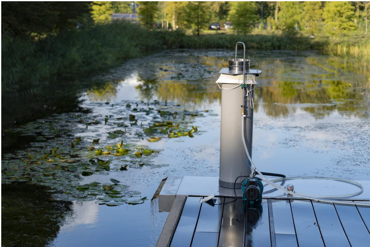
Figuur 2. Een draagbaar filter-systeem waarmee microplastics in het veld kunnen worden geconcentreerd.
