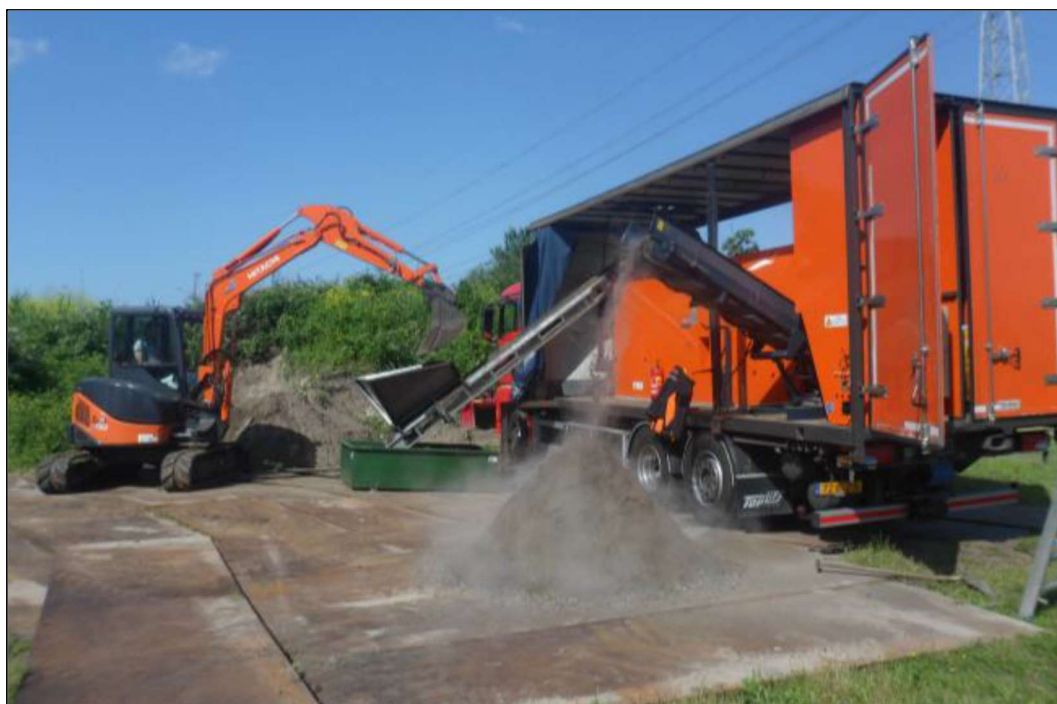
Figuur 13. De mobiele verhitter in werking, juni 2019 (Foto Iv-Infra)
