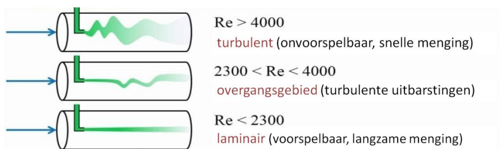
Afbeelding 4. Drie karakteristieke stromingsregimes
