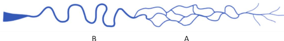
Afbeelding 1b. Algemeen beeld van een rivierloop met verschillende stromingsdynamische zones. A. Vlechtend, B. Meanderend. Naar [2]
