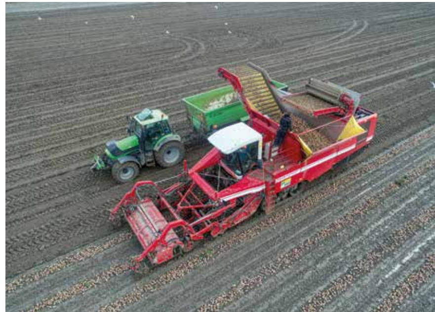
Voor de uien die in december nog moesten worden gerooid, is een aardappelrooier omgebouwd om er uien mee te kunnen laden.
