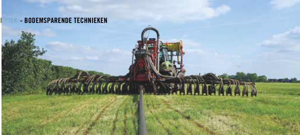
Bemesten met een sleepslang is inmiddels een ingeburgerde methode om de bodemdruk te verminderen.
