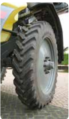
Michelin heeft met de Spraybib een VF-band voor spuitmachines in de markt gezet, die inmiddels ook door fabrikanten als eerste montage wordt aangeboden.
