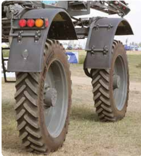
Een VF-band kan ook een oplossing zijn als er onder een spuitmachine geen ruimte is voor een hogere band, maar dat lijkt hier niet aan de orde.
