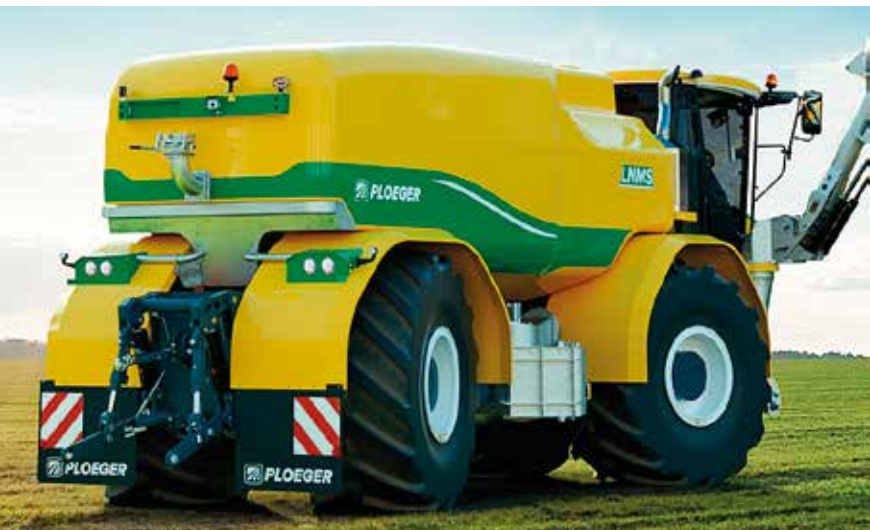
Ploeger zal dit jaar een prototype testen en de machine op de Agritechnica introduceren. Er is bewust niet voor een knikvoertuig gekozen om de complexe aandrijving door het knikpunt te vermijden.
