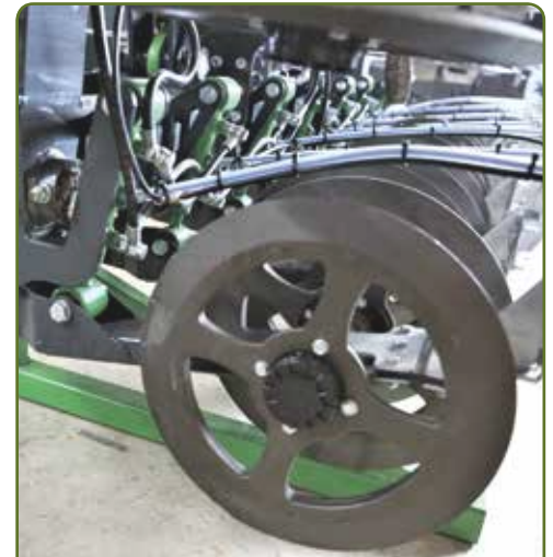
De zware gegoten schijven hangen aan torsierubbers onder de balk. Per twee schijven zorgt een cilinder voor de juiste bodemdruk.
