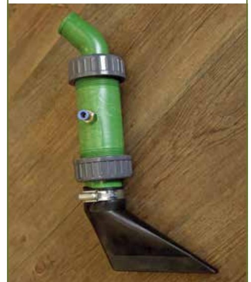
Eland kocht aanvankelijk de kunststof afsluiters in, maar laat ze nu naar eigen inzicht produceren. Ze zijn licht en zorgen voor een schone kopakker.
