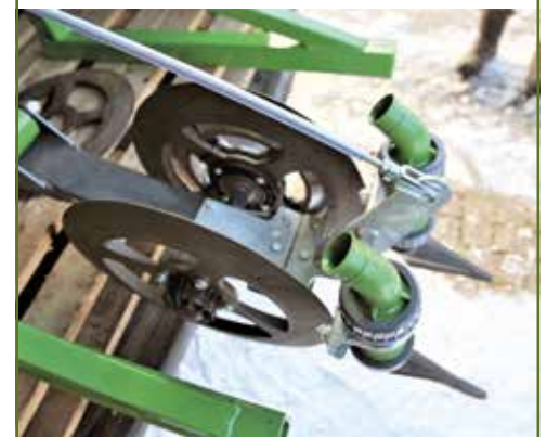
De trekstang vormt een parallellogram met de ophanging. Met het scharnierpunt achter de as zorgt dit ervoor dat de uitloop altijd horizontaal blijft.
