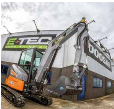
ELM heeft bewust gekozen voor de wat zwaardere 3,6-tons mini. Met het ingebouwde accupakket moet die in de Nederlandse praktijk een dag op een acculading kunnen draaien.
