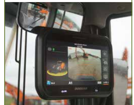
Op het nieuwe 8-inch-kleurenscherm zit niet alleen de achteruitkijkcamerafunctie. Je kunt via het Doosan Smart Guidance System (DSGS) aan de kleur zien hoe zuinig je werkt.
