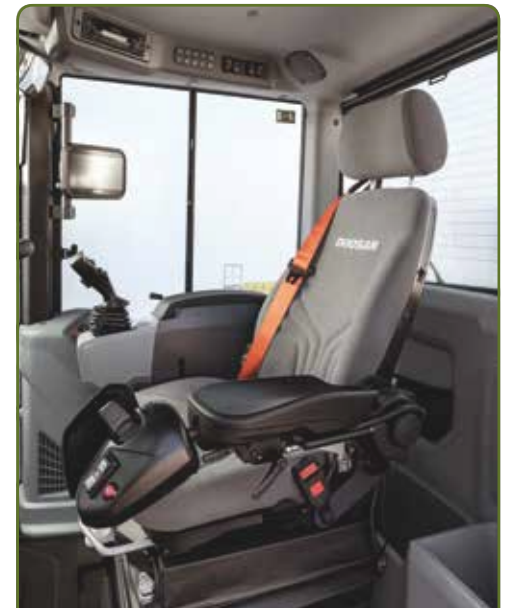
De cabine is ruimer, heeft meer naar beneden doorlopend glas en armleuningbediening aan de stoel.
