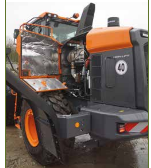
Voor de toegankelijkheid kun je het spatscherm wegklappen. De Doosan- en Scania-motoren halen de Stage V-norm zonder EGR.
