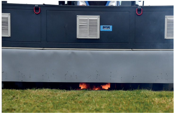
Gras wordt met 7.000 volt geëlektrocuteerd. De uitdaging is het gras goed te raken.
