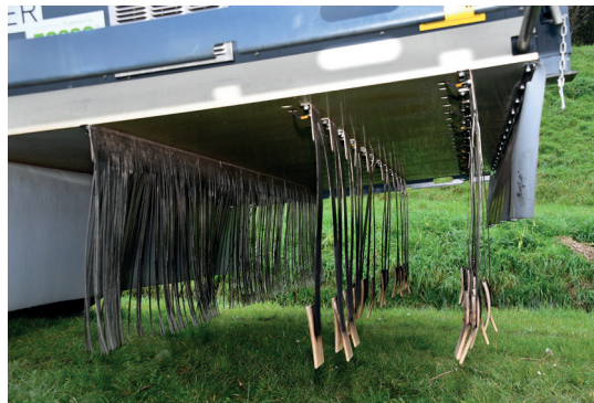
Gras wordt met 7.000 volt geëlektrocuteerd. De uitdaging is het gras goed te raken.
