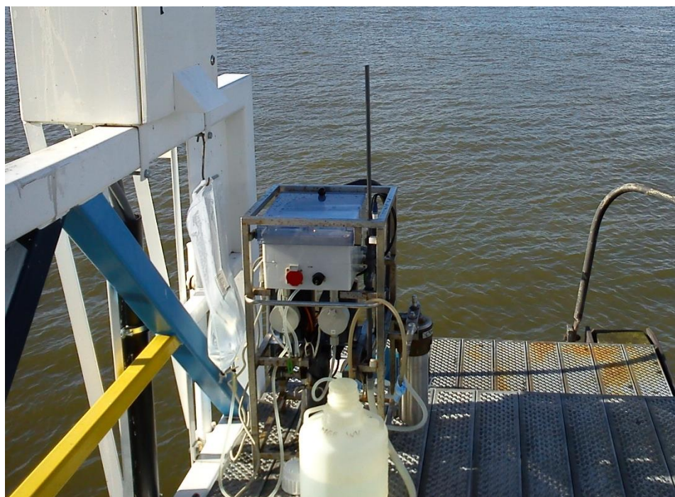
Afbeelding 2. Groot-volumebemonstering van enterovirussen in oppervlaktewater
