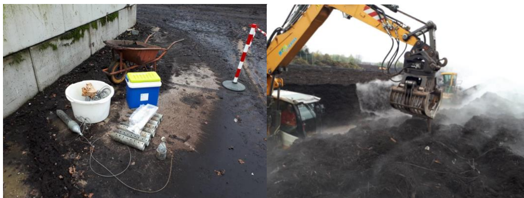
Figuur 5. Punten waarin de monsters en de temperatuursensors aangebracht zijn (rechts) en de kraan waarmee de punten tot een diepte van 1.5 m in het composterende materiaal in de tafel zijn gebracht. Foto en uitvoering Elsinga Beleidsplanning en Innovatie bij Van Iersel te Biezenmortel.
