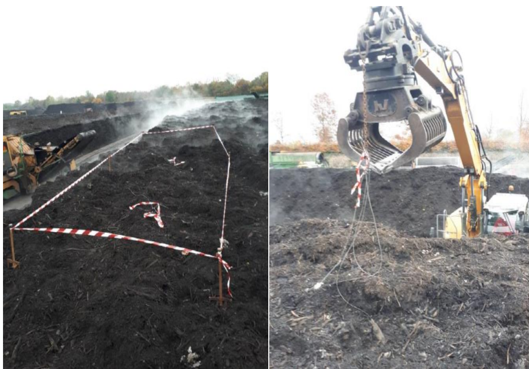
Figuur 6. Afzetting van de plaats waar de monsters en de temperatuursensors zijn aangebracht (rechts) en het uithalen van de punten. Foto en uitvoering Elsinga Beleidsplanning en Innovatie bij Van Iersel te Biezenmortel.
