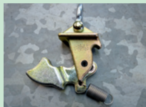
▲ Er zijn reparatiesets te koop om de vanghaken van een nieuwe vergrendeling te voorzien. Door twee holpijpen uit de vanghaak te tikken, neem je de gehele vergrendeling uit de vanghaak en kun je eenvoudig een nieuwe set monteren. Let op dat de veer op de juiste wijze wordt vastgezet.
