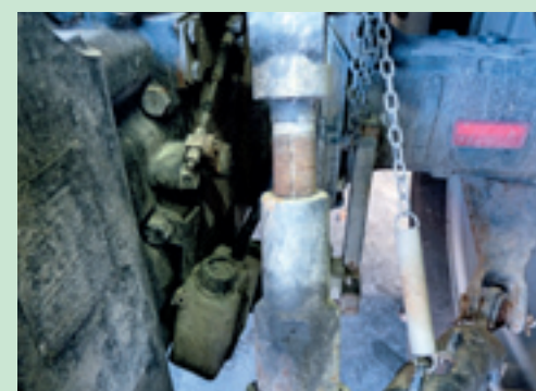
▲ De hefstangen zijn meestal voorzien van draadeinden om verstelling in de breedte mogelijk te maken. Door het fijne schroefdraad zit de zaak gauw vast door vuil en stof. Een oplossing kan zijn een kleine groef in de lengterichting van het schroefdraad te slijpen met een dunne schijf (geen haakse slijper!). De groef werkt dan als tap. Schraap wel het schroefdraad schoon en maak het gangbaar.
