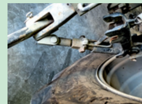
▲ Er worden vaak automatische vergrendelingen gebruikt. Handig bijvoorbeeld bij het ploegen. Dan moet je wel de borgring loshalen, zodat de beugel helemaal omhoog kan als je de hef laat zakken. Nadeel is dat je door de automaatfunctie bijna nooit meer aan de spindel draait, laat staan dat je weet dat je de spindel kunt verstellen. Ook hier geldt dat een beetje kopervet wonderen doet en ook na langere tijd de spindel gangbaar houdt.
