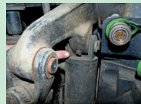
▲ De smeernippels op en rond de hefinrichting vallen niet erg op. Ze zijn wel belangrijk. Door de grote hefvermogens dienen de pennen goed gesmeerd te worden en ze mogen niet mee kunnen draaien. Is dat wel het geval, dan kunnen ze de holspie of borgbout afdraaien en is er kans dat de pen uit de cilinder trilt. De hefcilinder kan dan scheef gaan staan en bij heffen of zakken is er kans op afbreken van het bevestigingspunt.
