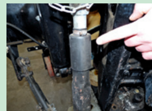
▲ Water, stof en kunstmest zijn funest voor de versteleinden van de hefstangen. Een eenvoudig beschermkapje helpt een hoop ergernis voorkomen. Natuurlijk moet u af en toe alsnog de draadstang invetten, maar water en stof hebben geen vrije toegang meer. Deze oplossing is ook eenvoudig zelf achteraf aan te brengen en het is bovendien goedkoop.
