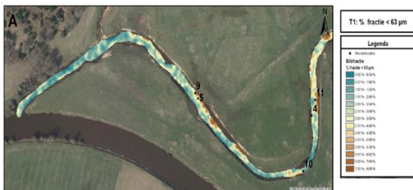
Afbeelding 3 Metingen met een gammaspectrometer vanaf een boot om de substraatsamenstelling van de onderwaterbodem in kaart te brengen.
