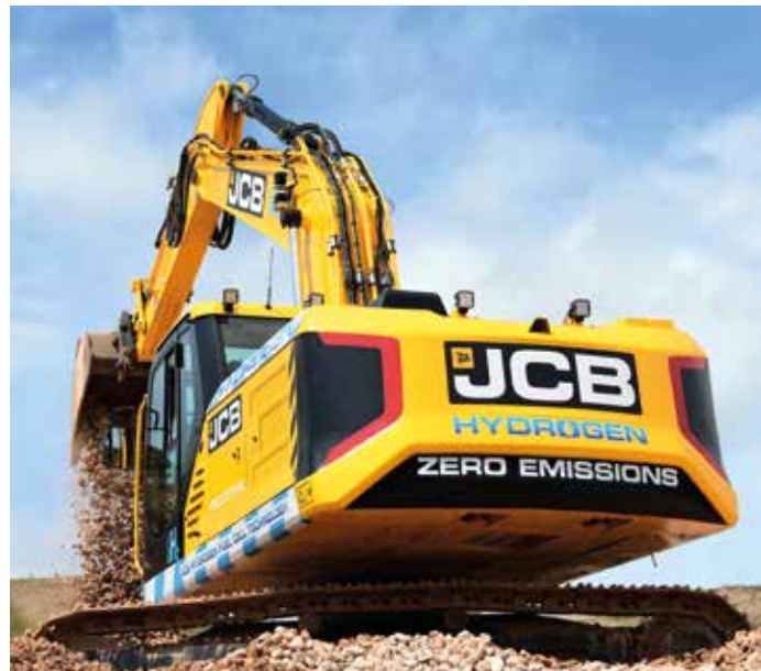
JCB zet bij ontwikkeling van zero emissie bij de zwaardere machines in op waterstofoplossingen. Zo heeft het dit prototype van een Hydrogen-rupsgraafmachine met brandstofcel al laten zien.
