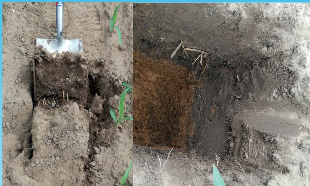
Figuur 5: Met het graven van een profielkuil kunnen verdichte lagen zichtbaar worden gemaakt. Ook kan men zo bekijken tot hoe diep de beworteling doordringt.
