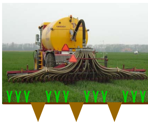
Figuur 4. Mest injecteren op niet-beteeld bouwland met een aan de mestmachine gekoppeld werktuig (links). Met een zodenbemester toedienen van mest op beteeld bouwland (rechts); de mest wordt in sleufjes in de grond gebracht.
